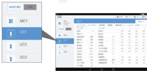
Monitorização do estado de operação do controlador de módulo e de unidade!
