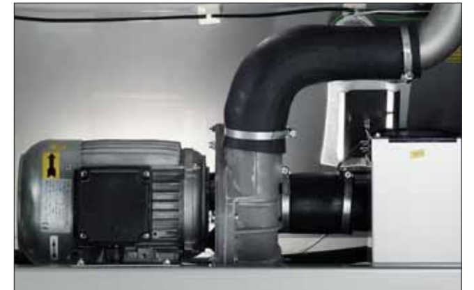
Bomba de lavagem
