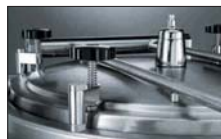
Tampa autoclave com válvula de segurança.
